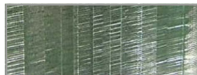
Narzędzie konwencjonalne – ślady od drgań samowzbudnych
